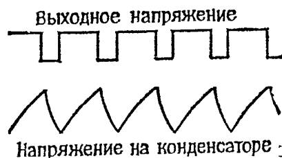
Рис. 4.7. Осциллограмма выходных сигналов мультивибратора, R_A = 4 \text{ Ом} , R_B = 3 \text{ кОм} , R_L = 1 \text{ кОм} . (С любезного разрешения фирмы Philips ECG Inc.)
