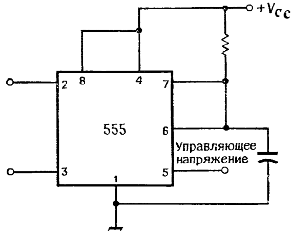
Рис. 4.12. Основная схема широтно-импульсного модулятора. (С любезного разрешения фирмы Philips ECG, Inc.)
