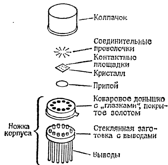
Рис. 1.6. Модифицированный корпус ТО-5 в разобранном виде
