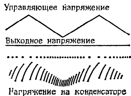
Рис. 4.15. Осциллограммы сигналов фазоимпульсного модулятора при модулирующем напряжении треугольной формы. R = 3 \text{ кОм} , R_B = 500 \text{ Ом} , C = 0,01 \text{ мкФ} , R_L = 1 \text{ кОм} . (С любезного разрешения фирмы Philips ECG, Inc.)
