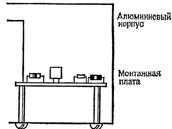
Рис. 6.8. Способ крепления монтажной платы в алюминиевом корпусе.
